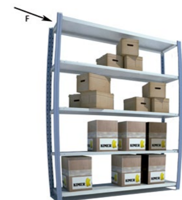
Für den Test der maximalen Kapazität muss das Rack überlastet werden und eine Kraft auf das obere Ende des Racks ausgeübt werden, um zu prüfen, ob sich die Pfosten verformen.
