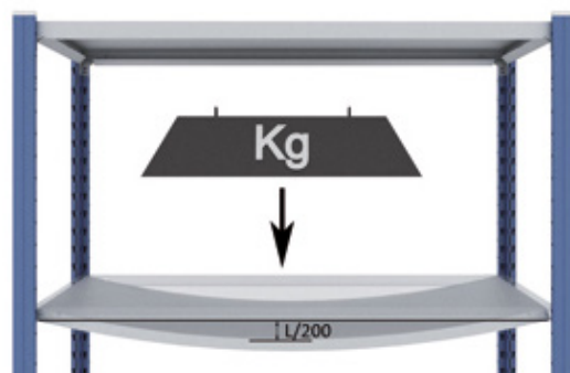
Maximal zulässige Durchbiegung \leq L/200 .
